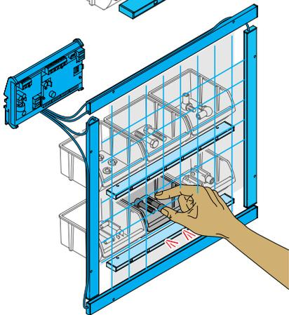
Eine zusätzliche Sicherheit bietet die Entnahmeüberwachung mittels Matrixauswertung.
